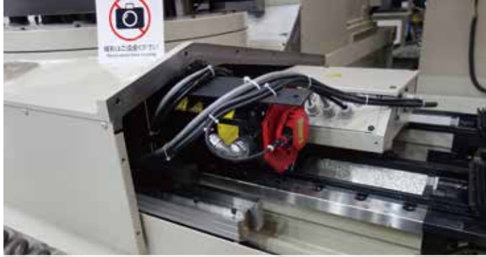
三井精機工業の高精度横形ジグボーラー『H6E』を「この姿」で展示するのは稀少。それは通常より何倍も手間のかかった(約2ヶ月)細かいキサゲをあえて見せるため
