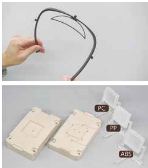
▲材料のPOMにより曲げ伸ばしできるフェイスガードの加工サンプル(上)、金型の代用として利用できる樹脂型の加工サンプル
