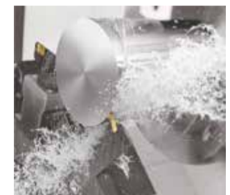
▲『Coro Turn Prime』=加工速度と送り倍にする全方向旋削加工により速く切りくずを除去し、より多くの部品の加工を実現する。
