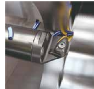
▲『Coro Turn Prime』=加工速度と送り倍にする全方向旋削加工により速く切りくずを除去し、より多くの部品の加工を実現する。
