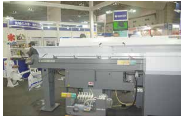
▲クーラント装置を供給機の下部スペースへ設置
