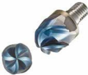
③ ボール部および外周刃のねじれ角度を大きくし、切削抵抗の低減、および、びびり振動を抑制した。ボール切れ刃のR精度は、φ16で8μm、φ20で10μmと高精度。
